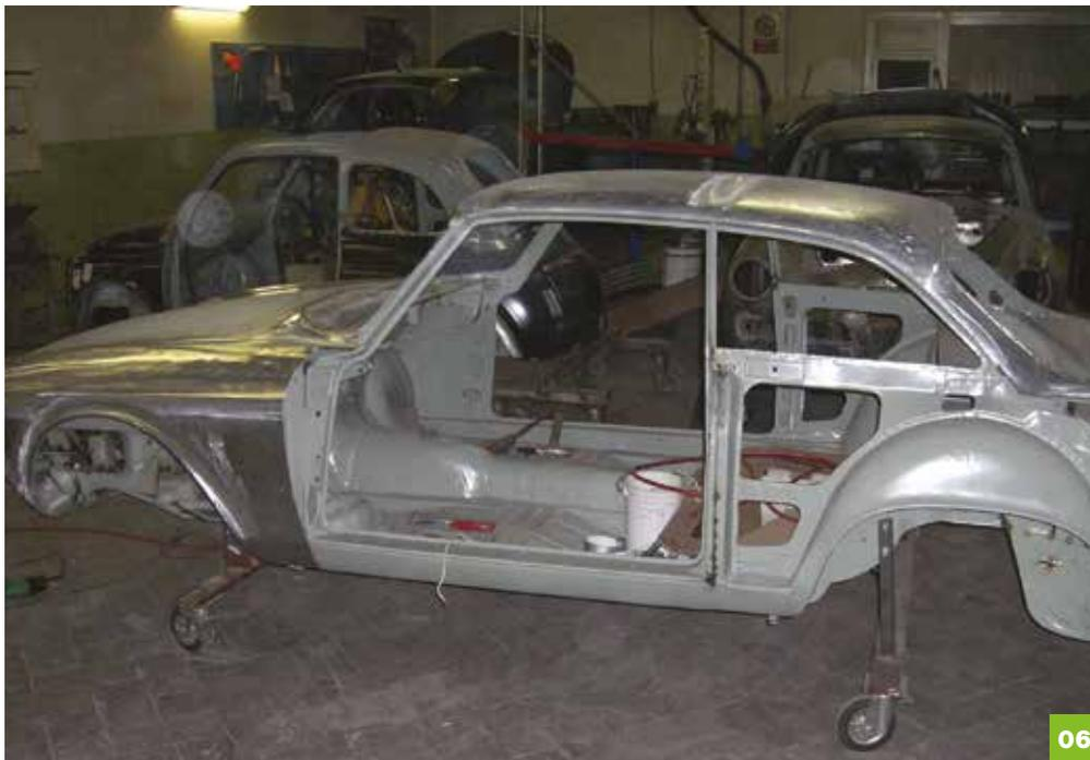
**06:** Per eseguire i necessari lavori di ripristino o sostituzione della pelle in Peralluman della carrozzeria, questo è stato separato dalla struttura del telaio in acciaio.
